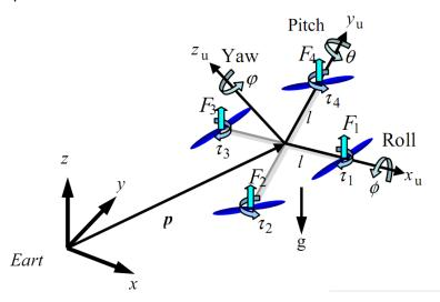
$$\begin{bmatrix} m & 0 & 0 \\ 0 & m & 0 \\ 0 & 0 & m \end{bmatrix} \begin{pmatrix} \ddot{x} \\ \ddot{y} \\ \ddot{z} \end{pmatrix} + \begin{pmatrix} 0 \\ 0 \\ mg \end{pmatrix} + K_f \begin{pmatrix} \dot{x} \\ \dot{y} \\ z \end{pmatrix} = R(\phi, \theta, \varphi)F$$
