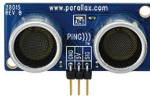
Figure 4. Parallax Ping))) Sensor
