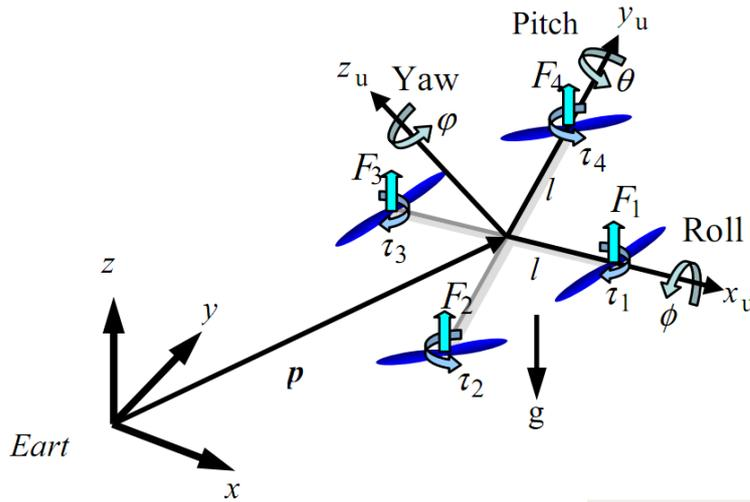
$$\begin{bmatrix} m & 0 & 0 \\ 0 & m & 0 \\ 0 & 0 & m \end{bmatrix} \begin{pmatrix} \ddot{x} \\ \ddot{y} \\ \ddot{z} \end{pmatrix} + \begin{pmatrix} 0 \\ 0 \\ mg \end{pmatrix} + \mathbf{K}_f \begin{pmatrix} \dot{x} \\ \dot{y} \\ \dot{z} \end{pmatrix} = R(\phi, \theta, \varphi) F$$
